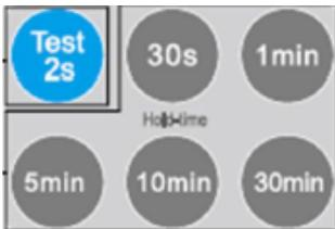
Réglez la temporisation d'allumage du luminaire : Pour cela, appuyez sur les boutons « Hold Time » en fonction du besoin. 5 réglages possibles : 30s, 1min, 5min, 10min et 30min. Un mode « Test » de 2 secondes est également présent.
