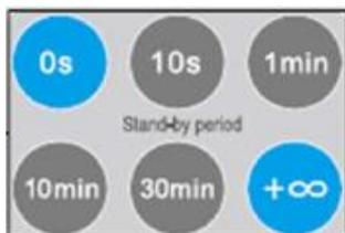
Réglez la durée de maintien du préavis d'extinction : Pour cela, appuyez sur les boutons « Stand-by-period » en fonction du besoin. 6 réglages possibles : 0s, 10s, 1min, 10min, 30min, +∞.
