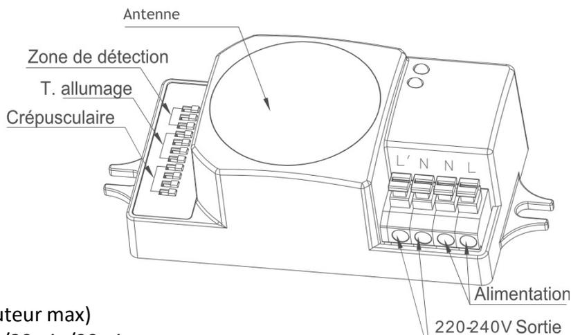
*Cet appareil est un détecteur; Il émet un signal électromagnétique de haute fréquence (5.8GHz) et reçoit son écho. Il est conseillé de faire des essais pour régler précisément la sensibilité du détecteur. Il est possible qu'il détecte à travers des portes, ou des murs de faible épaisseur s'il est mal réglé.*
