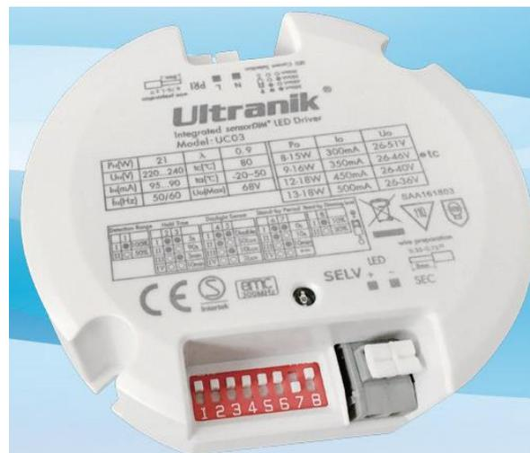
Cet appareil est un détecteur; Il émet un signal électromagnétique de haute fréquence (5.8GHz) et reçoit son écho. Il est conseillé de faire des essais pour régler précisément la sensibilité du détecteur. Il est possible qu'il détecte à travers des portes, ou des murs de faible épaisseur s'il est mal réglé.
