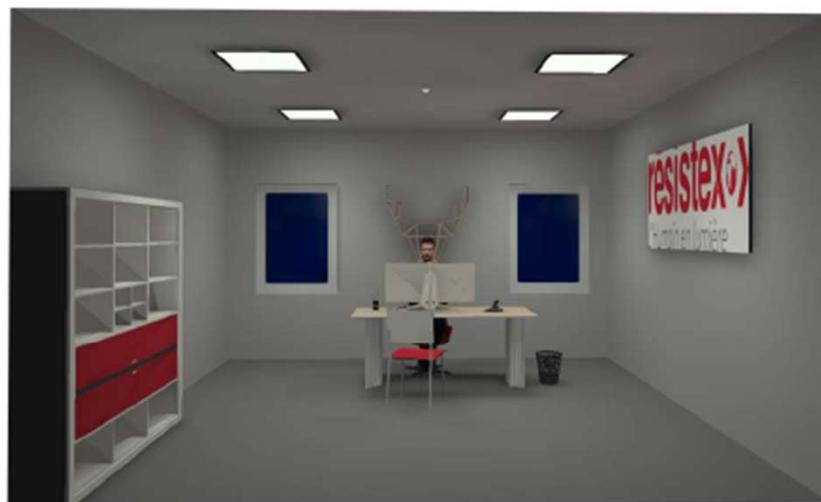
Si la lumière naturelle n'est pas suffisante la cellule allume automatiquement les luminaires lorsqu'une présence est détectée. La luminosité des luminaires s'adapte en fonction du nombre de lux prédéfini dans la cellule.
