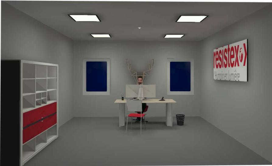
Si la lumière naturelle n'est pas suffisante la cellule allume automatiquement les luminaires lorsqu'une présence est détectée.
