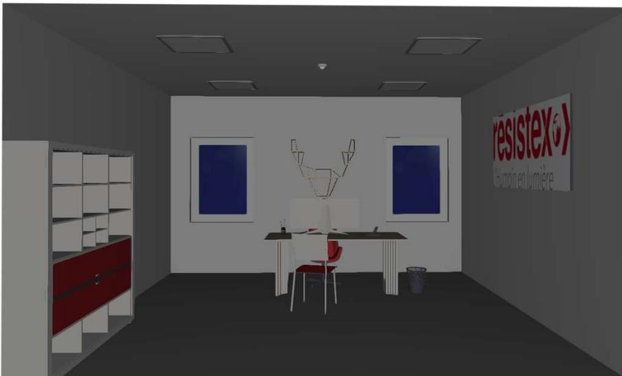
Après le temps de maintien les luminaires s'éteignent automatiquement lorsqu'aucun mouvement n'est détecté.
