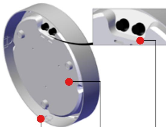
Entrées défonçables sur les 4 «côtés» aux dimensions des goulottes les plus utilisées du marché (10x20mm ; 12,5x32mm ; tube IRO Ø20mm).
