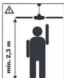
Même avec sa lampe, l'AUREA garantit une hauteur sous plafond de minimum 2m30 entre le sol et les pâles. Il est donc parfaitement adapté pour les plafonds de 2m50.
