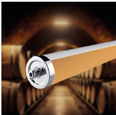
Spectre lumineux concentré autour de la longueur d'onde 600nm (ambre), longueur d'onde spécifique permettant de ne pas altérer le goût de vin - IP 67, étanche à la poussière, température de fonctionnement -20°C/+35°C.
